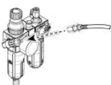
Fig. 50: Conexión de aire comprimido
