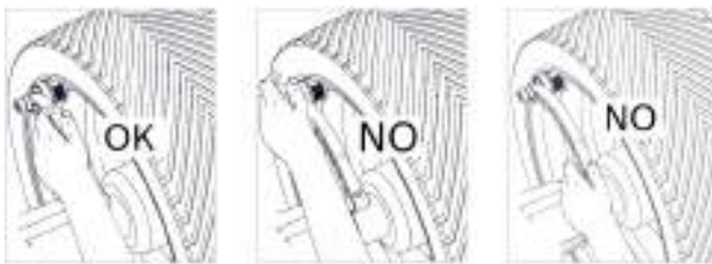
Fig. 28: Corretta manipolazione del calibro a corsoio elettronico
