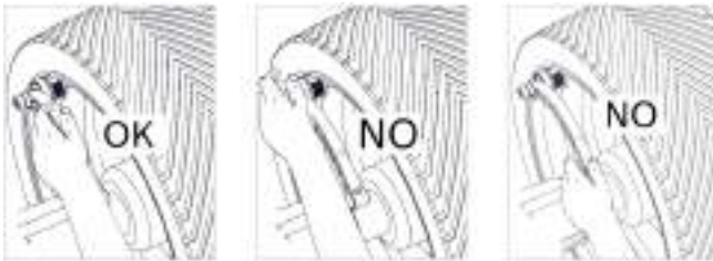
Abb. 28: Korrekte Handhabung des elektronischen Messschiebers
