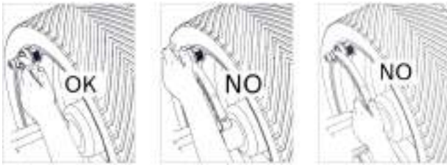
Fig. 28: Manejo correcto de la corredera de medición electrónica
