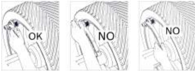
Fig. 28: Manipulation correcte du coulisseau de mesure électronique
